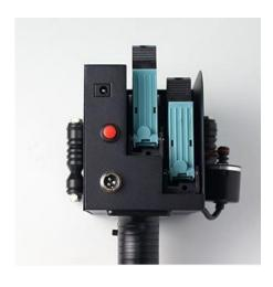
3. После поднимите фиксаторы вверх до щелчка
