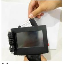
2. Вставляем картриджв маркиратор под углом 45°, осторожно втолкните вперед до выхода сопла.
